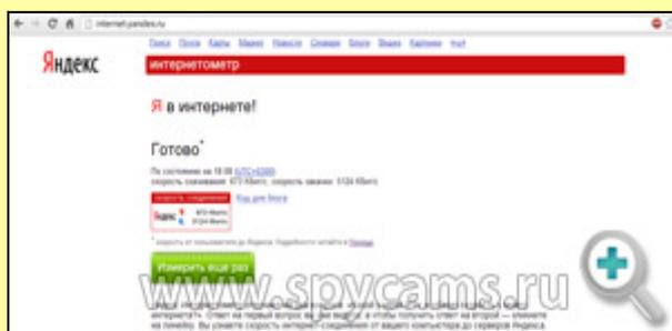
Нас интересует второй параметр - "**скорость закачки**", который определяет скорость исходящего потока (отдачи). В данном примере этот параметр равен 5124 кбит/сек, что равняется точно 5 Мбит/сек (5124 надо разделить на 1024, чтобы привести к Мбит).
